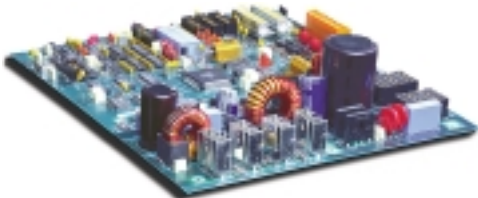
Tarjeta Electrónica del Módulo de Control y Protección (CAPM)
